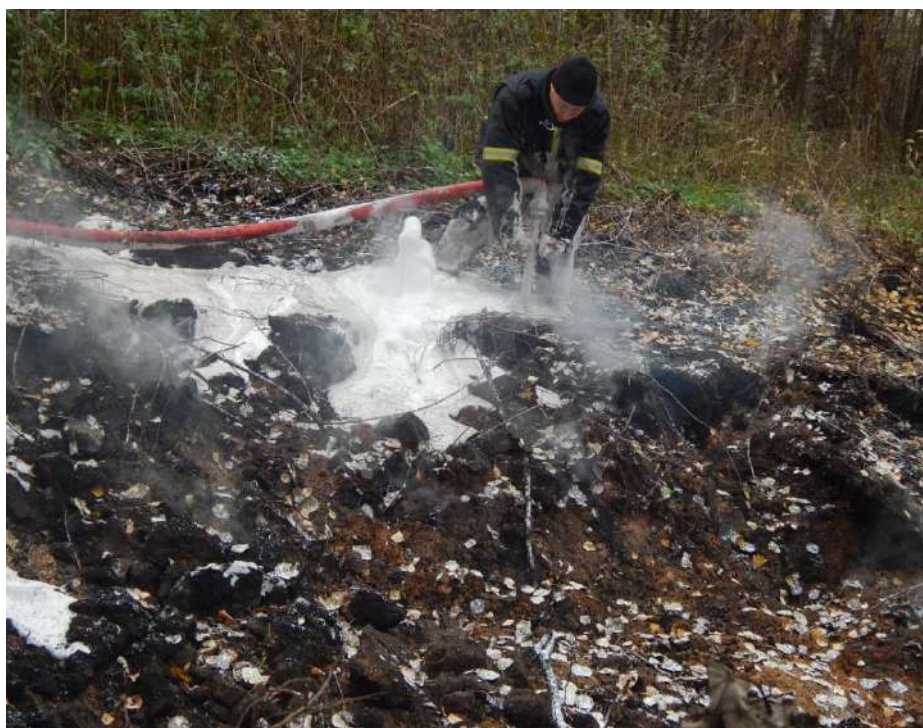
Рис. 3. Тушение торфяного пожара компрессионной пеной с использованием модернизированного торфяного ствола
