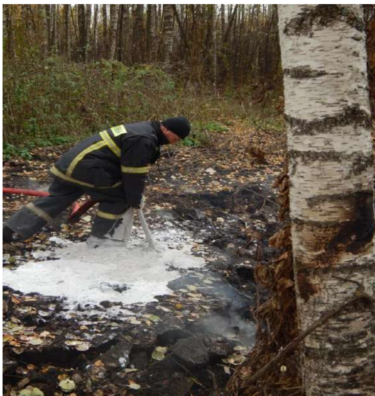
Рис. 4. Вытекание компрессионной пены на поверхность слоя торфа
