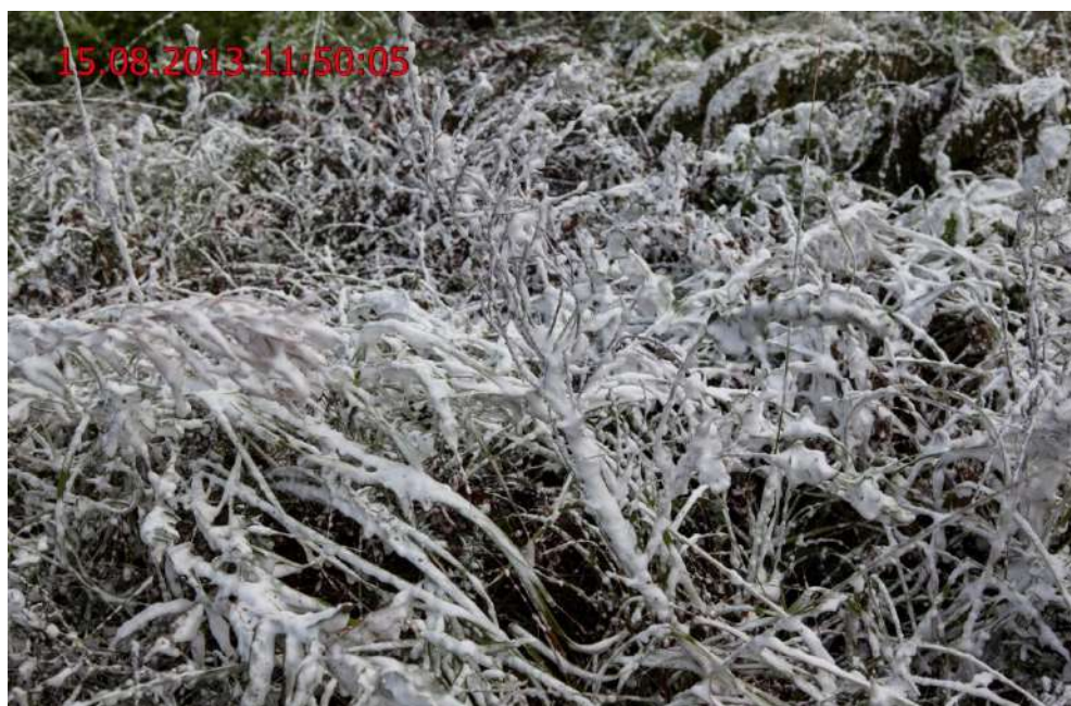
Рис. 1. Внешний вид компрессионной пены (сухой) на поверхности растительности через 4 мин. после подачи ее на растительный покров
